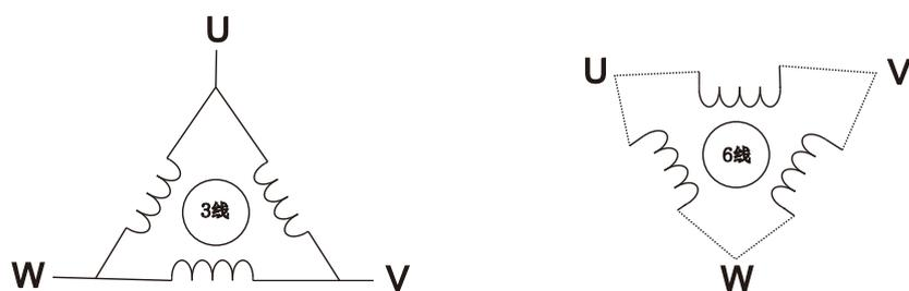
3R60 驱动器可以匹配的步进电机为低电阻低电感的三相混合式步进电机。
