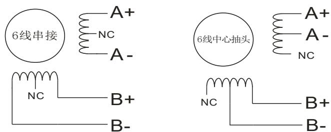
R86-CCW 驱动器可以匹配的步进电机为低电阻低电感的混合式步进电机。
