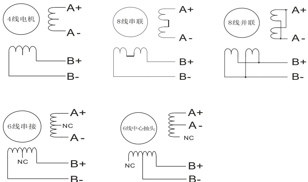
R60 驱动器可以匹配的步进电机为低电阻低电感的混合式步进电机。
