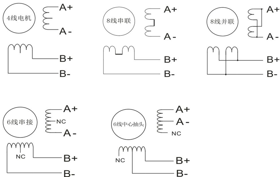
DMA860H 驱动器可以匹配的步进电机为低电阻低电感的混合式步进电机。
