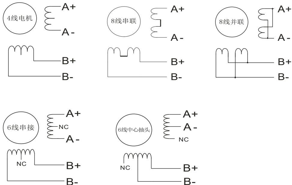
DM860 驱动器可以匹配的步进电机为低电阻低电感的混合式步进电机。
