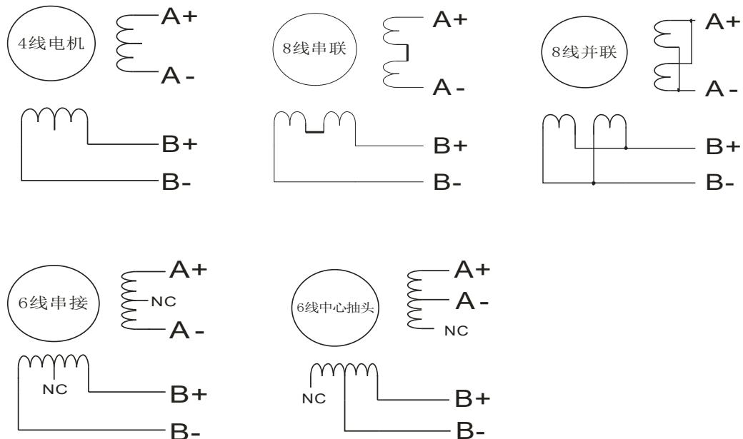
DM542 驱动器可以匹配的步进电机为低电阻低电感的混合式步进电机。
