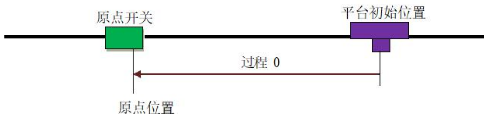
图 3-6 一次回零方式示意图
