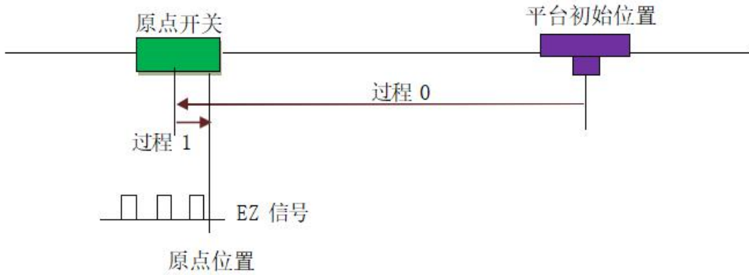
图 3-15 原点锁存加反向 EZ 锁存进行回零方式示意图
