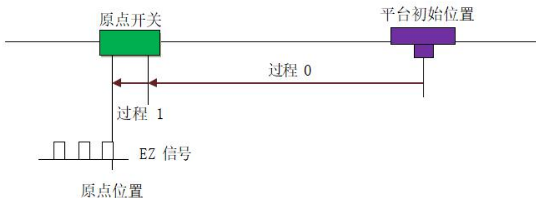
图 3-13 原点锁存加同向 EZ 锁存回零方式示意图
