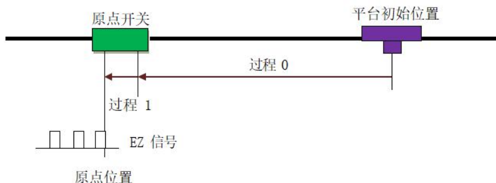
图 3-9 一次回零后再找 1 个 EZ 信号回零方式示意图
