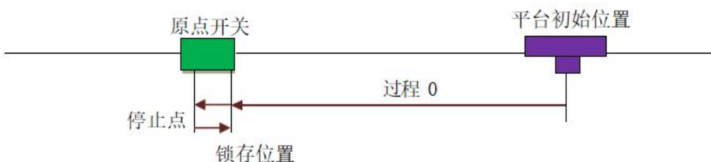
图 3-12 原点锁存回零方式示意图
