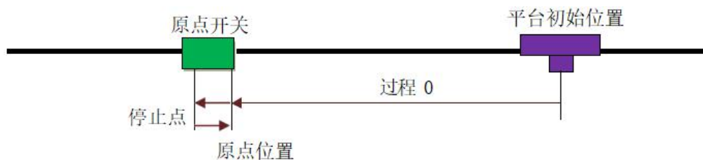
图 3-7 一次回零加回找方式示意图
