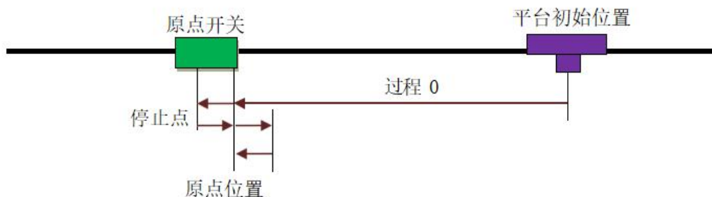
图 3-8 二次回零方式示意图
