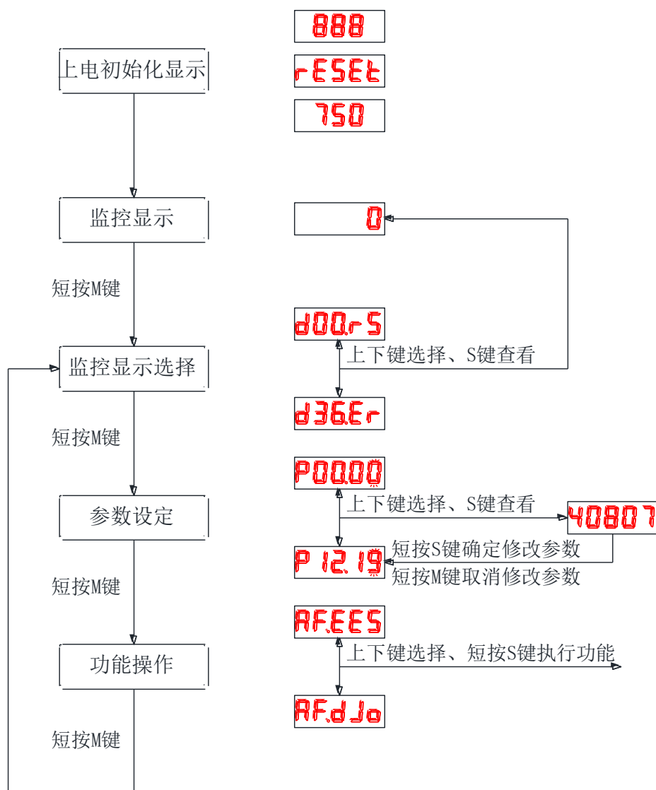
图 4-1 伺服驱动器面板操作示意图
